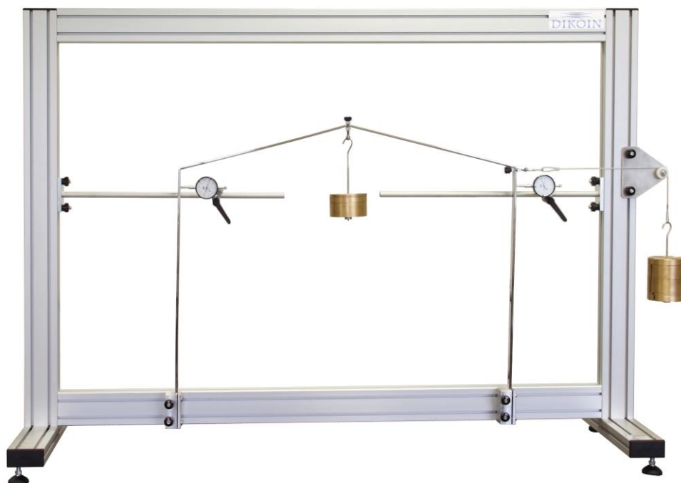
Vista pórtico a dos aguas montado.
